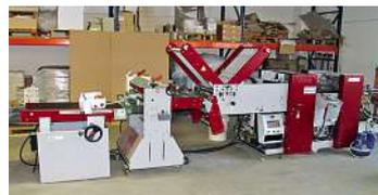
*Die Petratto-Balkenrillmaschine bei PVP: Rillen/Falzen in einem Arbeitsgang mit Materialien bis 450 g/m<sup>2</sup>.*
