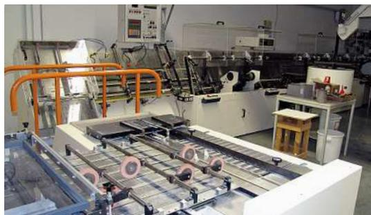
*Im Linkslauf der tb flex werden Loseblattwerke mit einem Zwei-Stapel-System zur Sammelstation (Auslage) transportiert. Der Rechtslauf übergibt gesammelte Kalender zur Weiterverarbeitung an eine Drahtkamm-Bindemaschine.*
