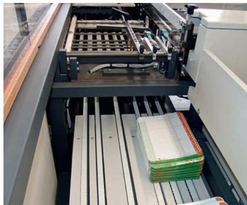
Im Linkslauf werden Loseblattwerke mit einem Zwei-Stapel-System zur Auslage transportiert. Der Rechtslauf übergibt gesammelte Kalender zur Weiterverarbeitung an die Drahtkammbindemaschine.
