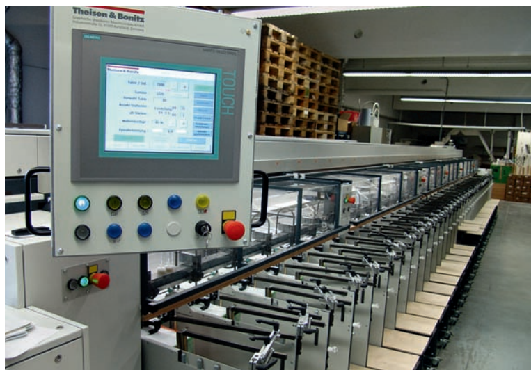
Die neue TB Flex B220 HP mit 40 Stationen im B3-Format oder 20 Stationen im B2-Format von Theisen & Bonitz kommt bei PVP bei der Produktion von Kalendern, Broschüren und Loseblattwerken zum Einsatz.
