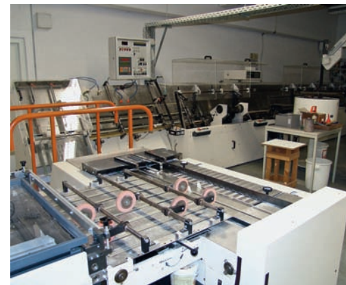
Im Linkslauf werden Loseblattwerke mit einem Zwei-Stapel-System zur Auslage transportiert. Der Rechtslauf übergibt gesammelte Kalender zur Weiterverarbeitung an die Drahtkammbindemaschine.
